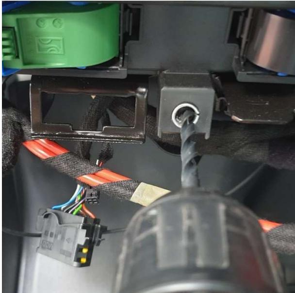
*Gewinde mit einem 6er Metallbohrer durchbohren.*
