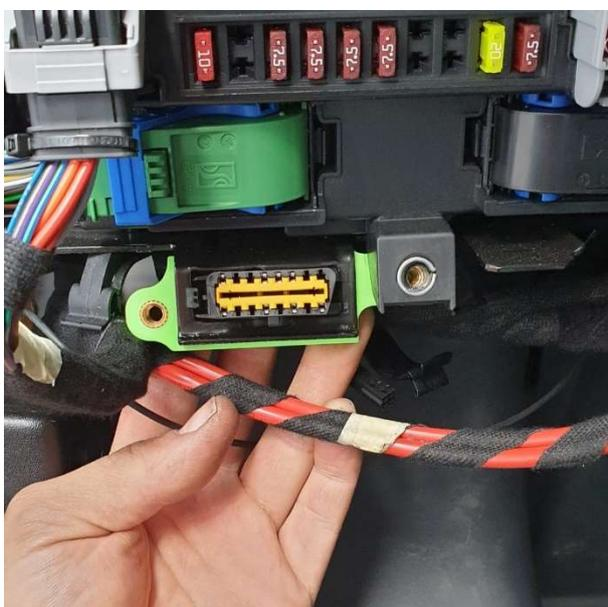
*OBD Anschluss wieder einklipsen und hinteren OBD Lock Halter positionieren. Zur leichteren Montage kann man das rote Doppelkabel aushängen und die Kabelschellen verdrehen, danach wieder alles einhängen.*
