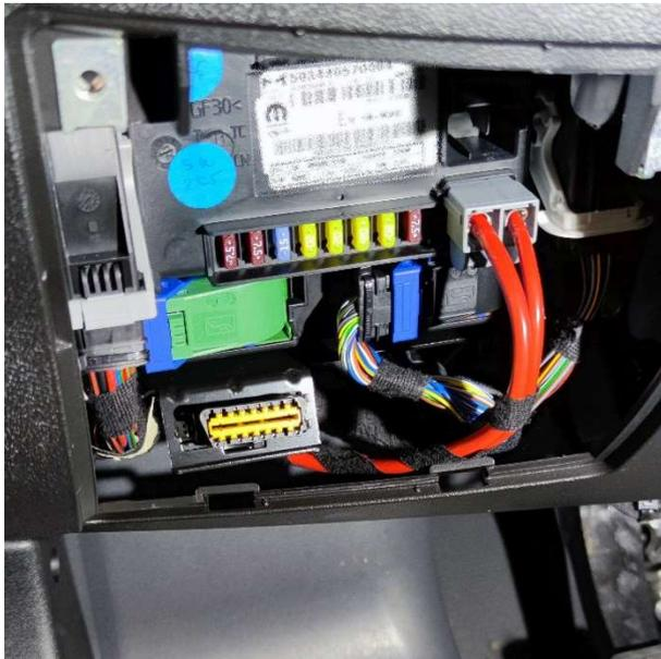
*Abdeckung entfernen. Der Einbau wird erleichtert, wenn man die Große Abdeckung auch entfernt, diese ist mit 3 Schrauben (je nach Fahrzeugalter mit Kreuz oder TX25) gesichert.*
