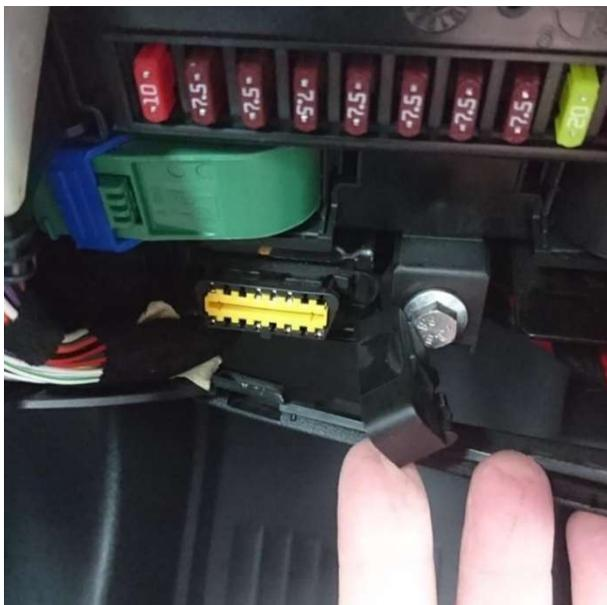
*Je nach Alter des Fahrzeug, kann noch eine Schutzkappe vorhanden sein, diese mit einem Cutter entfernen.*
