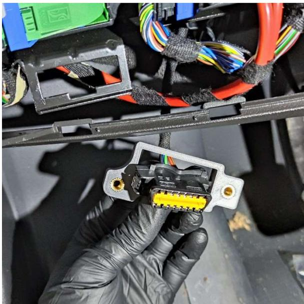
*OBD Anschluss durch hinteren Teil des OBD Lock führen.*
