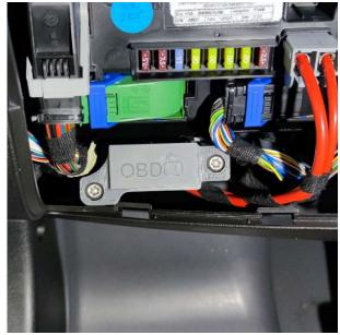
Vorderen Teil des OBD Lock aufsetzen und mit den mitgelieferten Sicherheitsschrauben und -bit Handfest anziehen.
